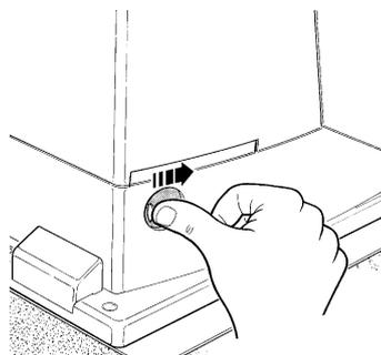
2 Introduire la clé et la tourner dans le sens des aiguilles d'une montre
